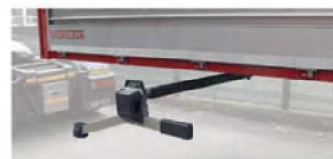
Alineador de Direcciones sin Cables (BlueTooth), con opción al alineado de los semi-remolques
